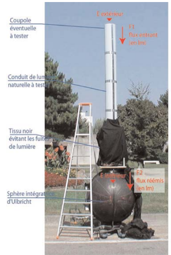
Figure 11 : Installation de mesure
